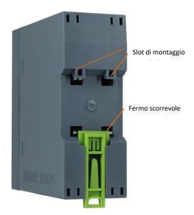
Per montare l'ACT350 su una guida, aprire il fermo premendolo verso il basso, quindi posizionare il trasmettitore in modo che gli slot superiori si fissino sulla guida DIN.
