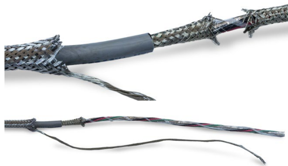
Abbildung A-36: Inneres Schirmgeflecht abziehen
