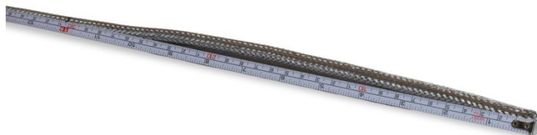
Abbildung A-28: Äußeres Schirmgeflecht vor dem Schneiden abmessen
