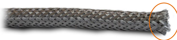
Abbildung A-27: Abgeschnittenes POWERCELL-Kabel
