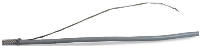
Abbildung A-30: Zurückgeschnittenes äußeres Schirmgeflecht
