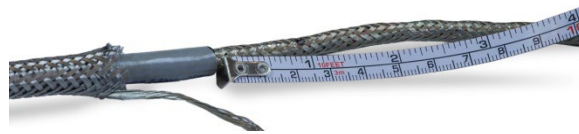
Abbildung A-35: Inneres Schirmgeflecht markieren
