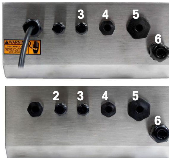
Abbildung A-17: Kabelstutzenzuweisungen, Netzstrommodell (oben) und Akkumodell (unten)
