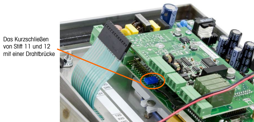
Abbildung 5-4: Drahtbrückentest für Ein-/Aus-Taste
