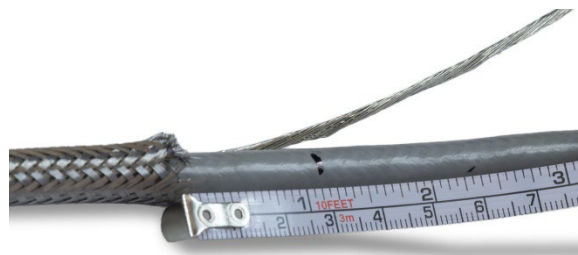
Abbildung A-31: Kabelummantelung markieren
