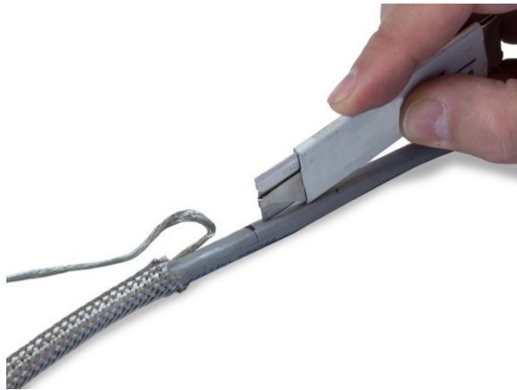
Abbildung A-33: Kabelummantelung aufschneiden
