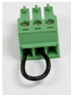
Abbildung 5-11: Drahtbrücke zwischen COM1-Sende- und Empfangsklemmen
