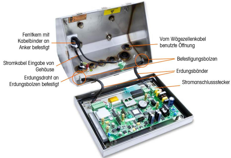
Abbildung A-4: Vorbereitung auf das Lösen der Vorderplatte
