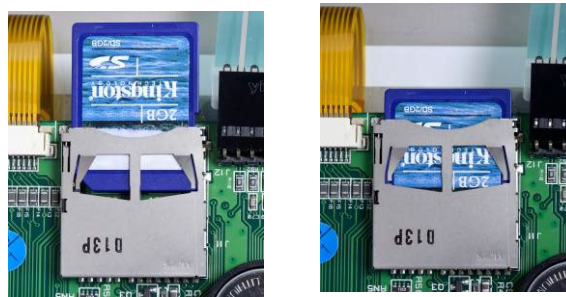
Abbildung A-70: SD-Karte in den SD-Sockel schieben (links); SD-Karte installiert (rechts)
