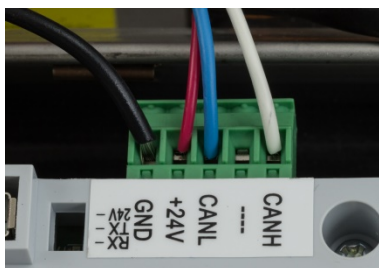
Figura 2-78: Conexión del cable PowerMount en la tarjeta principal.
