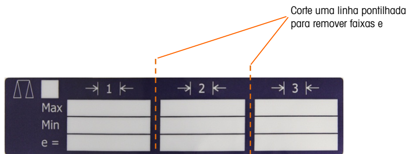
Figura 2-124: Preparação da Etiqueta de Capacidade
