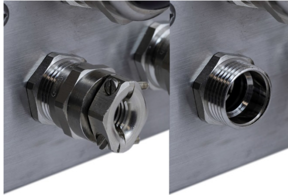
Abbildung 2-66: Abschrauben der Mutter der Kabeldurchführung
