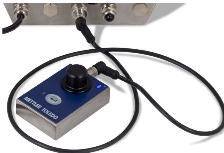
Figure 2-35: Module Bluetooth connecté à l'IND570
