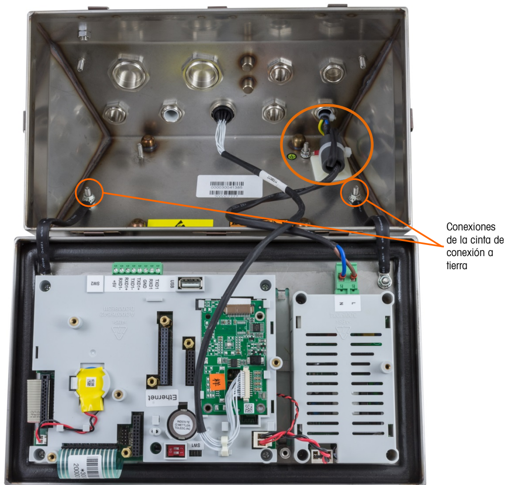
Figura 2-14: Para aflojar las cintas de conexión a tierra
