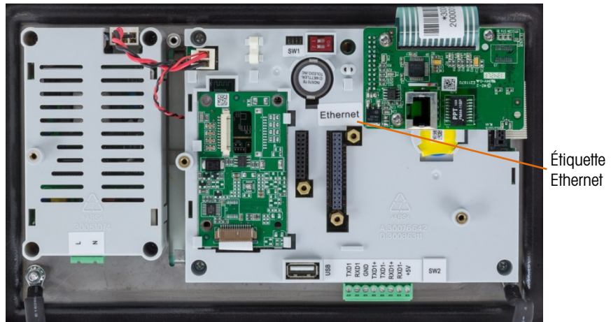
Figure 2-96 : Option Ethernet installée sur la carte principale
