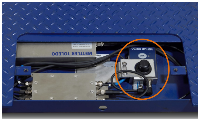
Figura 2-36: Módulo Bluetooth de la báscula
