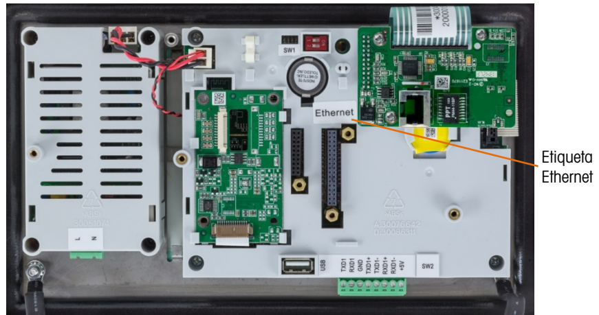
Figura 2-96: Opção Ethernet Instalada na Placa Principal
