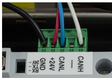
Abbildung 2-76: PowerMount-Kabelanschluss an der Hauptplatine
