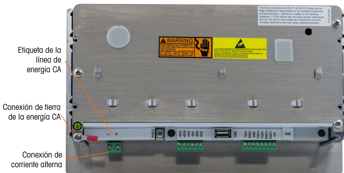
Figura 2-29: Conexión de energía CA en montaje en panel
