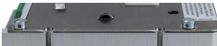
Figura 2-127: Viti di sigillatura installate
