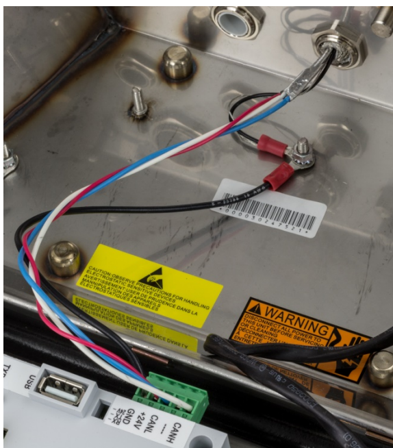
Figura 2-79: Cableado de la caja para ambientes externos PowerMount completo
