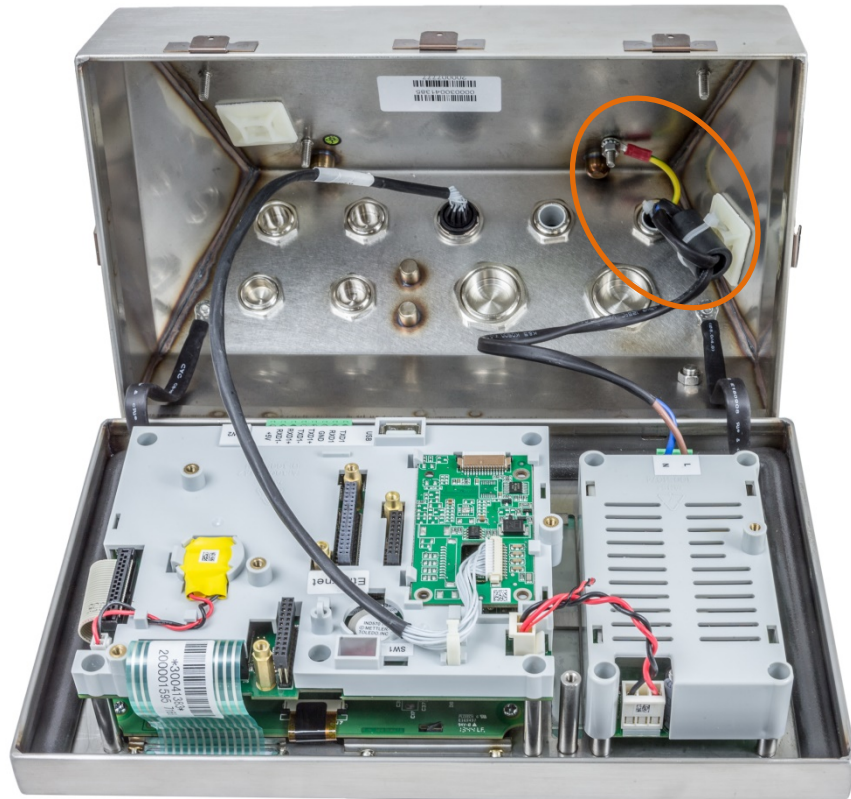
Figura 2-17: Panel frontal y conexión de celda de carga invertidos
