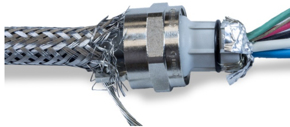
Abbildung 2-44: Gekürzte und über die Kunststoffülle gelegte Innenabschirmung und Folie
