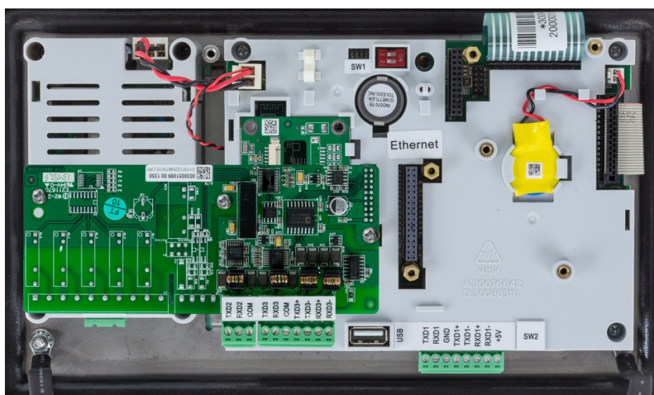
Figure 2-99 : Carte en option COM2/COM3, installée
