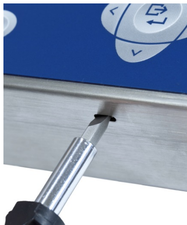
Figure 2-4 : Ouverture de l'enceinte pour environnement difficile
