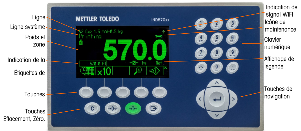
Figure 1-10 : Agencement du panneau avant de l'IND570
