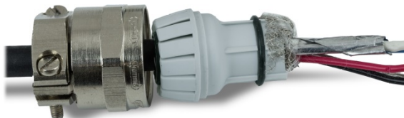
Figura 2-71: Blindaje interno separado y plegado sobre la arandela de plástico
