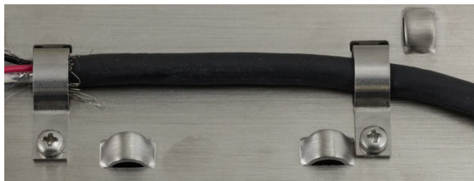
Figura 2-85: Cabo PowerMount Fixado
