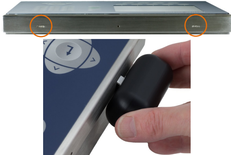
Abbildung 2-2: Gehäuse für raue Umgebungen öffnen, bevorzugte Methode
