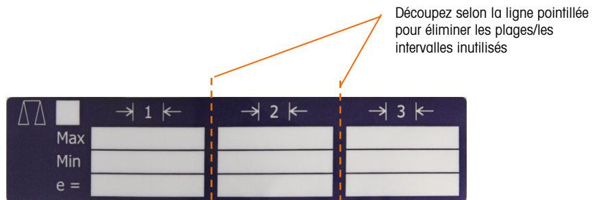
Figure 2-124 : Préparation de l'étiquette de capacité
