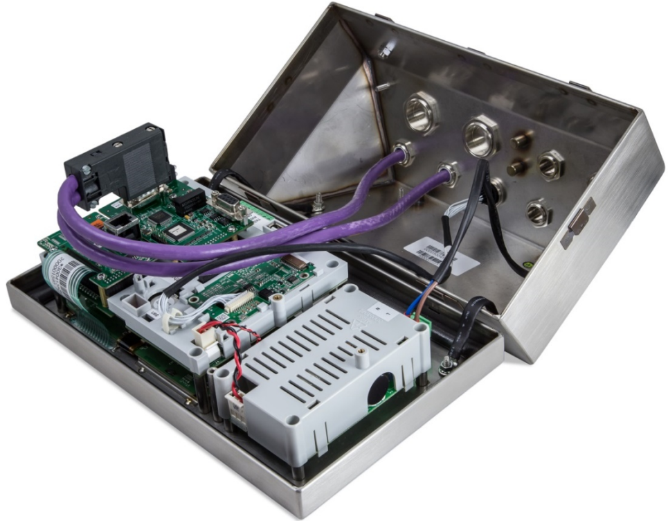
Figure 2-116 : Connexion d'un câble PROFIBUS dans une enceinte pour environnement difficile
