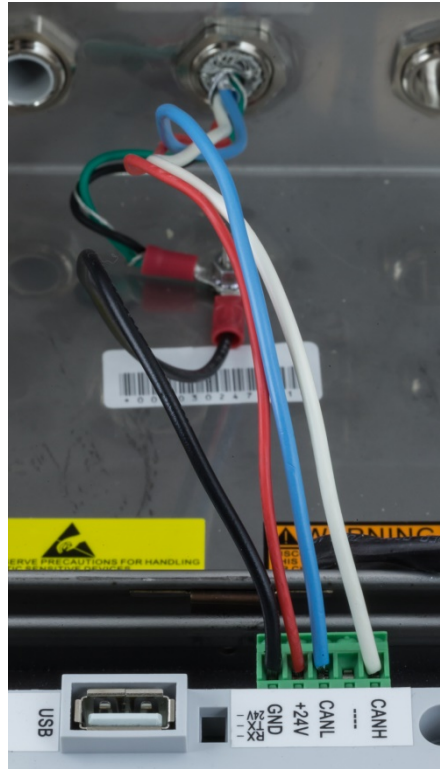
Figura 2-60: Fios POWERCELL Conectados no Terminal
