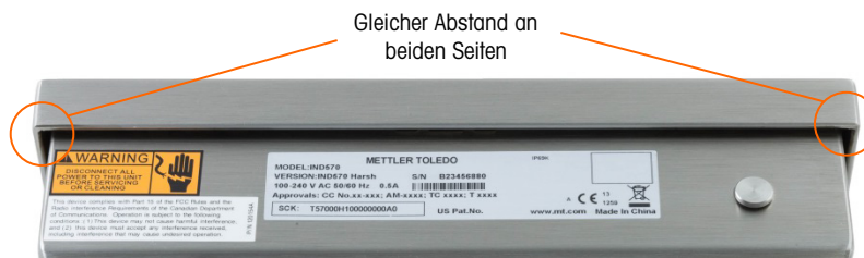
Abbildung 2-6: korrekte Ausrichtung der Frontplatte für das Gehäuse für raue Umgebungen
