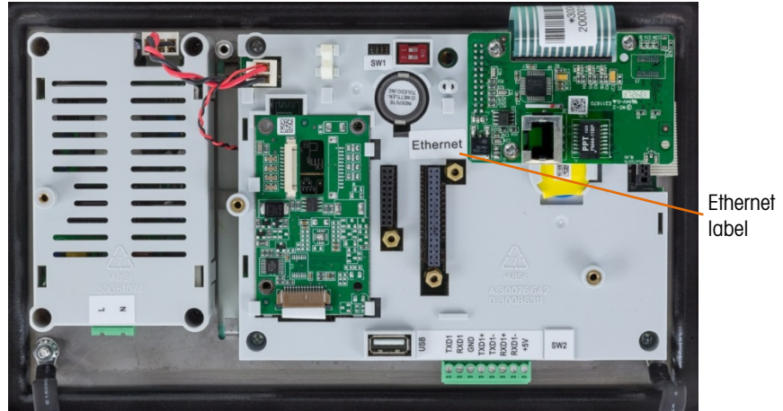
Abbildung 2-94: Ethernet-Optionsplatine auf der Hauptplatine
