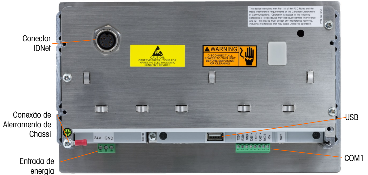
Figura 2-27: Conexões do Gabinete de Montagem em Painel, incluindo a Interface da Balança IDNet
