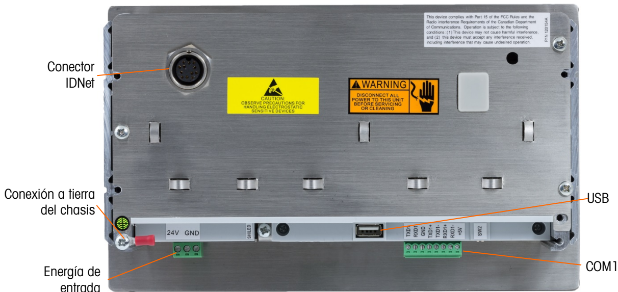
Figura 2-27: Conexiones de la caja para montaje en panel, incluyendo la interfaz de báscula IDNet
