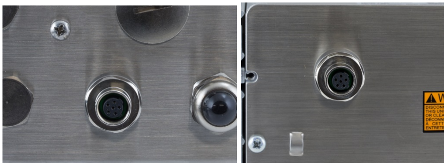
Figura 2-34: Ubicación del conector SICSPRO en las cajas para ambientes adversos (izquierda) y montaje en panel (derecha)
