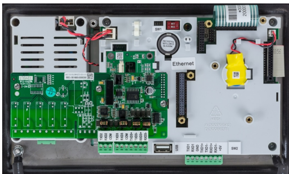
Figura 2-99: Scheda opzionale COM2/3 installata
