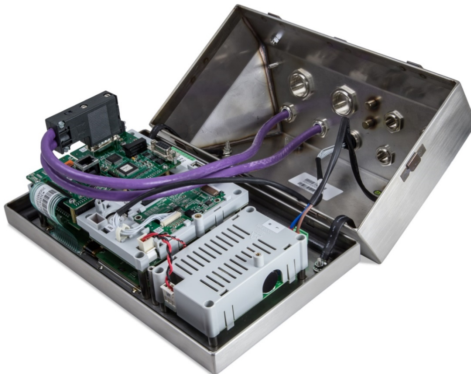
Figura 2-116: Collegamento del cavo PROFIBUS all'armadietto per ambienti difficili
