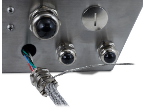
Abbildung 2-49: Einführung des Kabels in das Gehäuse
