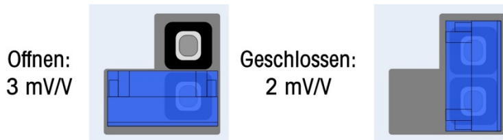
Abbildung 2-120: Positionen der Millivolt-Drahtbrücke W1
