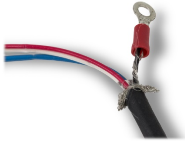
Abbildung 2-79: An schwarzer Ader und Beilaufdraht angebrachter Kabelschuh
