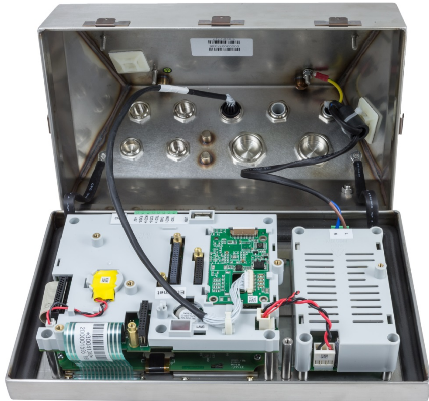
Abbildung 2-15: Frontplatte und Anschluss der Wägezelle von hinten
