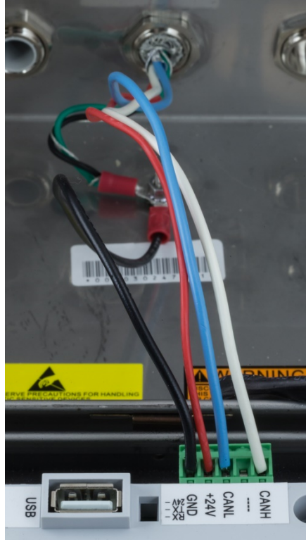
Figura 2-60: Alambres POWERCELL conectados en terminal
