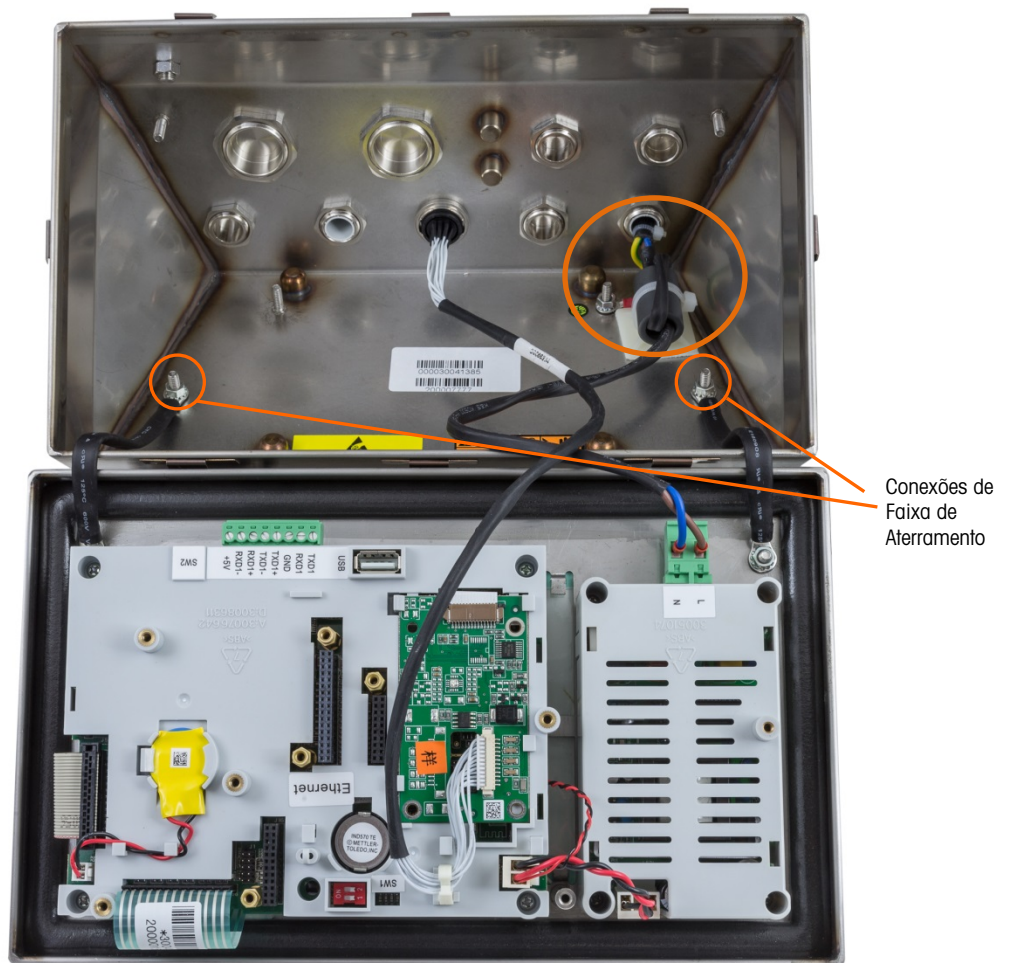
Figura 2-14: Solte as Faixas de Aterramento
