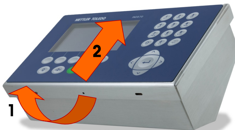
Figura 2-5: Remoção da tampa
