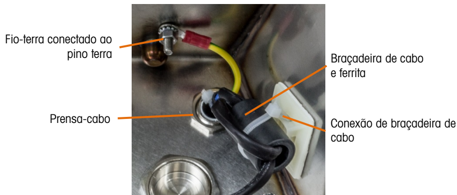
Figura 2-16: Localização reversa do cabo de energia
