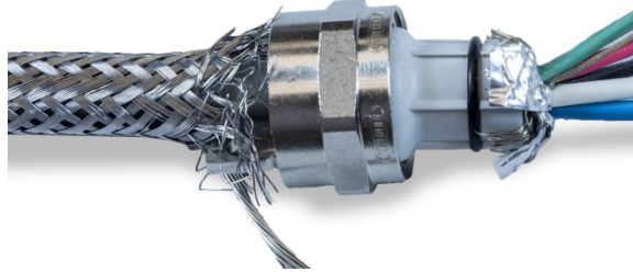
Figure 2-46 : Brins du blindage tressé intérieur et enveloppe métallique découpés à la longueur et repliés sur le passe-câble
