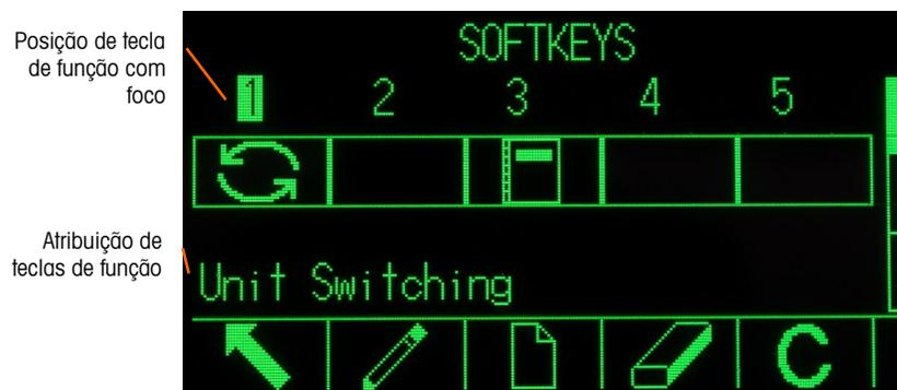
**Figura 3-18: Tela de configuração de teclas de função**
