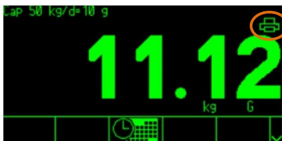
**Figura C-5: Status de Conexão da Impressora na Linha do Sistema**
