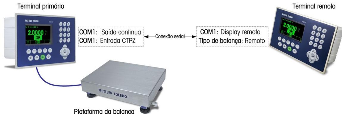
**Figura 2-18: Função de Display Remoto via Comunicação Serial**
