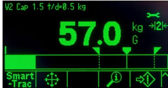
**Figura 1-11: SmartTrac de Transferência de Pequenos Materiais Ativado**
