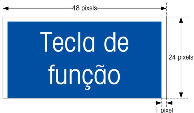
**Figura 3-20: Dimensões de imagem das teclas de função**
