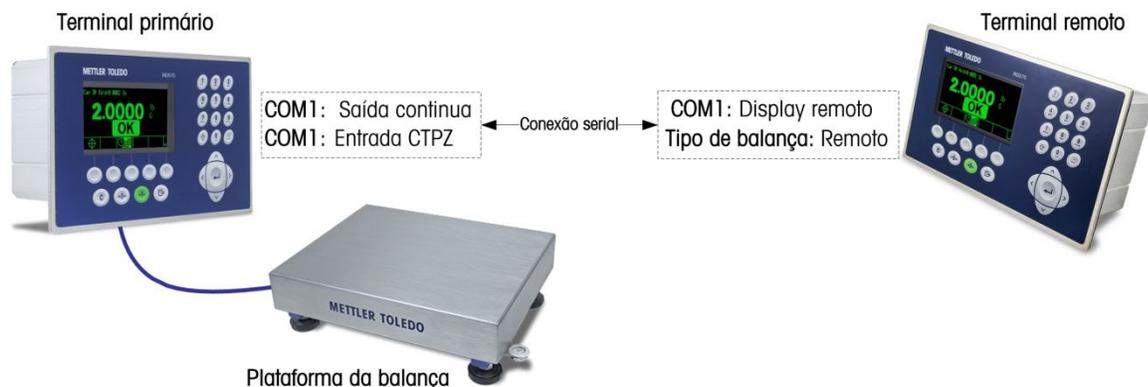
**Figura 4-15: Exemplo de Configuração de Terminal para Função de Display Remoto via Serial**
