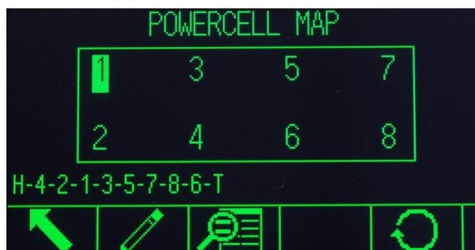
**Abbildung 3-35: Abgeschlossene POWERCELL-Wägezellenzuordnung**
