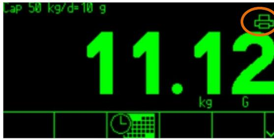
**Abbildung C-5: Verbindungsstatus des Druckers in der Systemzeile**
