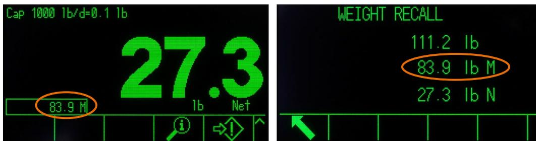
**Abbildung 2-15: Taraanzeigen mit aktivierter Nettozeichenkorrektur**
