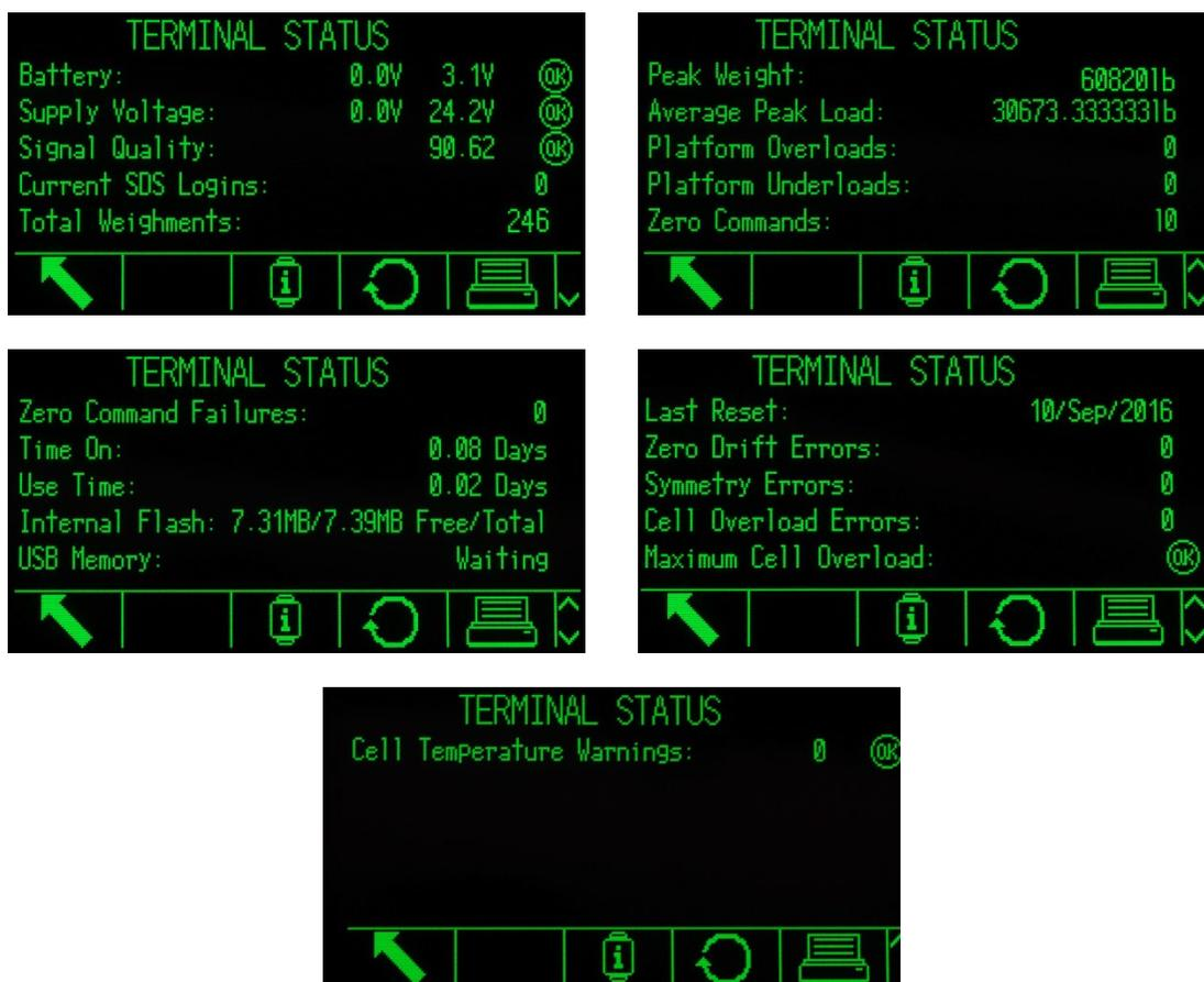
Abbildung 4-14: Terminalstatusbericht (POWERCELL), aktualisiert
