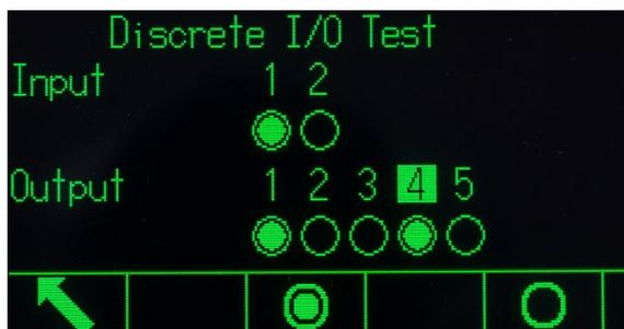
**Abbildung 5-16: Bildschirm für den Test der diskreten I/O-Schnittstelle**
