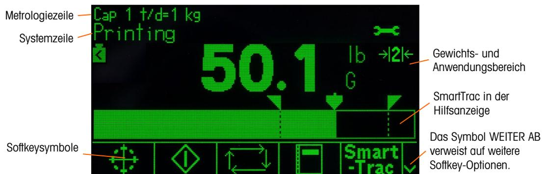
Abbildung 2-14: Standardausgangsbildschirm, Systemzeile mit Druckmeldung
