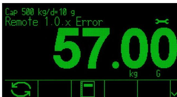
Abbildung 2-38: Anzeige des asynchronen Fehlers in der Systemzeile
