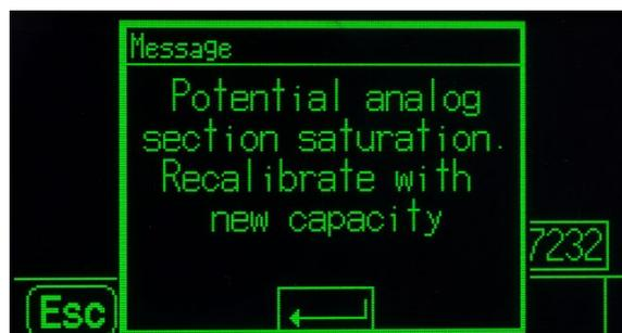
**Abbildung 3-8: Warnung bei Sättigung des Analogabschnitts**
