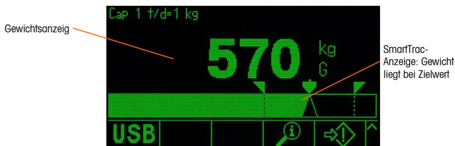
Abbildung 2-22: SmartTrac für Materialtransfer, klein
