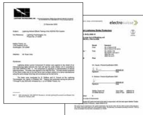
Das StrikeShield-Blitzschutzsystem wurde von den folgenden unabhängigen Labors gründlich getestet: Lightning Technologies, Inc. und Elektro Swiss AG. Tests mit POWERCELL PDX-Wägezellen haben die Fähigkeit des Systems unter Beweis gestellt, Blitzeinschläge von bis zu 80.000 Ampere zu überstehen, also mehr als das Doppelte eines durchschnittlichen Blitzeinschlags (30.000 Ampere).
