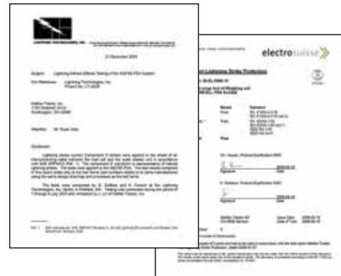
El sistema de protección contra rayos StrikeShield ha sido minuciosamente probado por laboratorios independientes: Lightning Technologies, Inc. y Elektro Swiss AG. Las pruebas con las celdas de carga POWERCELL PDX han demostrado que la capacidad del sistema para soportar rayos es de hasta 80,000 amperios, que es más del doble de la descarga eléctrica promedio de un rayo (30,000 amperios).
