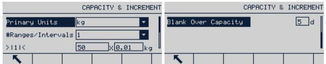
Abbildung 3-9: Die Bildschirme Kapazität und Schrittweite
