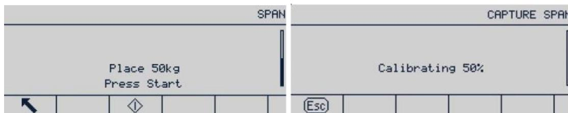
**Abbildung 3-15: Messspannenkalibrierung wird durchgeführt**
