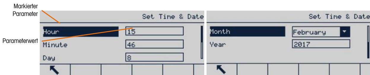
Abbildung 3-4: Beispiel für einen Setup-Bildschirm (Uhrzeit- und Datumseinstellung)
