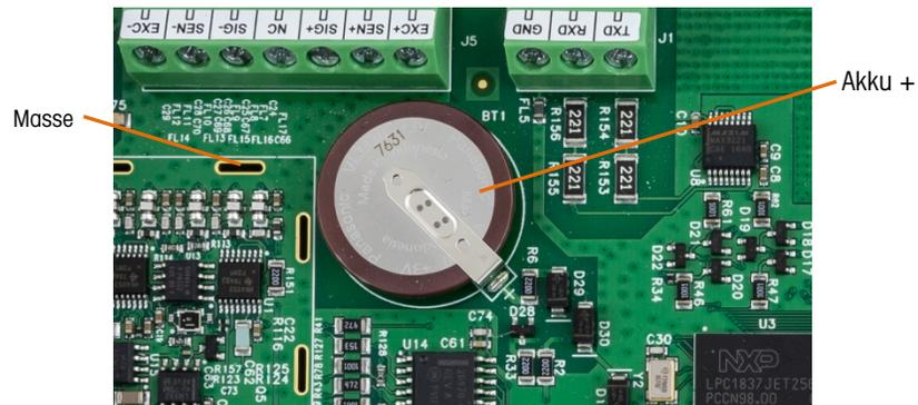
**Abbildung 4-4: Akkuprüfung**
