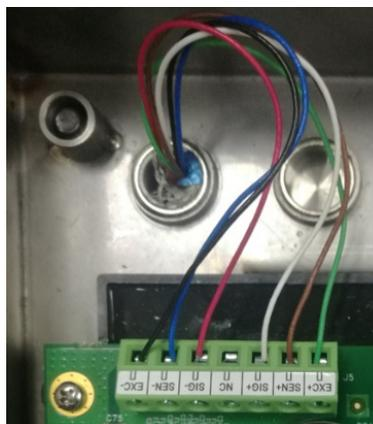
Abbildung 4-3: Anschluss der analogen Wägezelle
