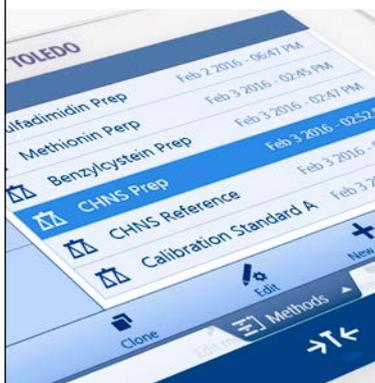
Para garantizar la uniformidad de los procesos, guarde los métodos de tareas usados en su propia biblioteca de métodos. Basta con tocar el nombre del método para acceder a todos los detalles y, a continuación, iniciarlo. También sirve para métodos que incluyan varias muestras o una serie de ensayos.
