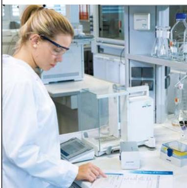
GWP® Verification proporciona instrucciones para verificar el rendimiento de la balanza, ahorrará tiempo y dinero. Se incluyen una planificación óptima de calibración y comprobaciones periódicas, especificaciones de las pesas de control necesarias y el plan de mantenimiento idóneo.
