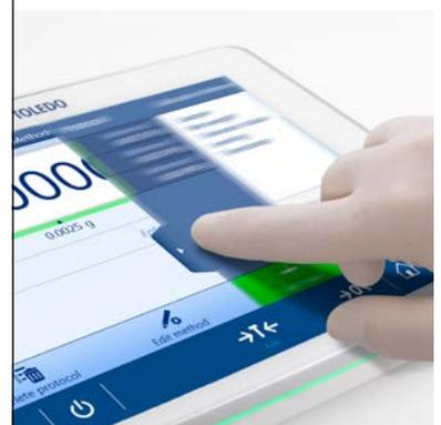
La nueva pantalla táctil capacitiva le permite "deslizarse" a través de sus tareas, así como emplear varios dedos para introducir datos. La pantalla se puede usar incluso con gruesos guantes resistentes a los productos químicos, como los de las cajas de guantes.
